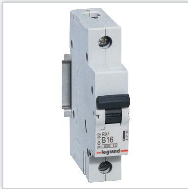
Legrand, Wyłączniki nadprądowe RX 3 – rozwiązania jedno- i trójbiegunowe; zdolność zwarcia 6000 A (zgodnie z normą EN 60898-1); charakterystyki B i C; prądowy znamionowy 10, 16, 20 i 25 A.
