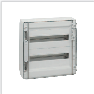
Legrand, XL 3 125 – rozdzielnice naścienne o szerokości 18 modułów z drzwiami przezroczystymi lub białymi w komplecie. Stopień ochrony: IP40 – IK09 z drzwiami. Znamionowe napięcie pracy: 400 V AC – 50/60 Hz. Izolacyjność: II klasa ochronności.
