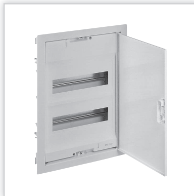
Legrand, RWN – rozdzielnice wgnętkowe o szerokości 12 modułów z drzwiami metalowymi w kolorze białym w komplecie. Stopień ochrony: IP40 – IK07 z drzwiami. Znamionowe napięcie pracy: 400 V AC – 50/60 Hz. Izolacyjność: II klasa ochronności.
